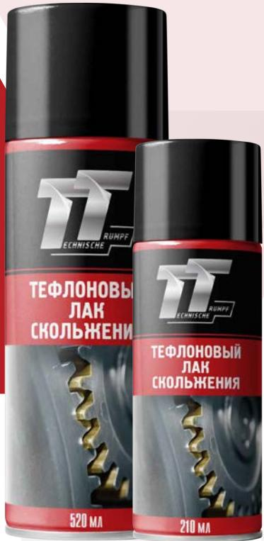
Тефлоновый лак скольжения – это бесцветное антифрикционное покрытие на основе ПТФЭ с акриловым связующим, отверждаемое при нормальной температуре; Применяется в узлах трения: подшипники скольжения, направляющие скольжения, зубчатые передачи (закрытые/открытые), гибкие валы в оболочках и уплотнения. При его применении устраняется процесс прилипания, а также облегчается скольжение.
